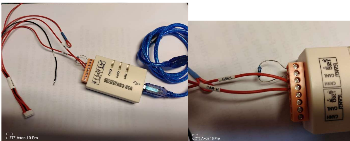
CAN-Bus Adapter mit welchem das Flashen funktioniert hat. Erworben bei Ali-Express. Das Kabel (USB und Anschluss CAN-Port am BMS) lag dem CAN-Bus Adapter bei. Abschlusswiderstand 120 Ohm
