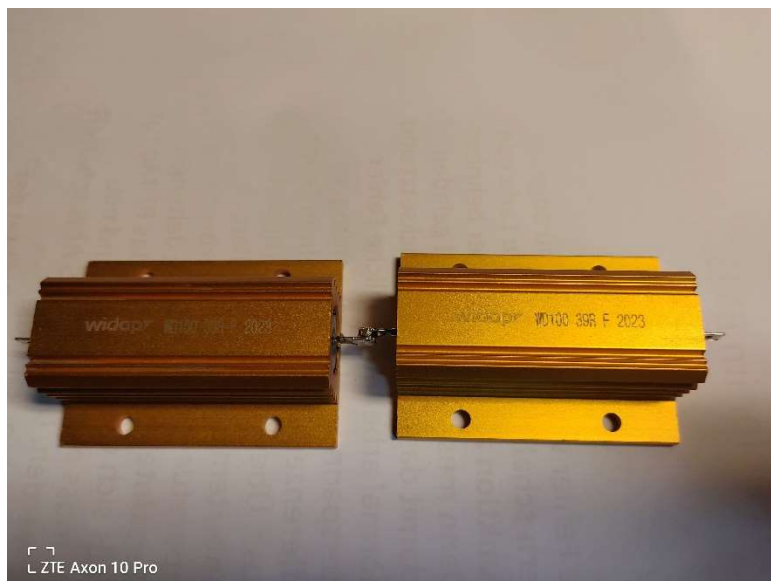
Abbildung 4 2 Hochlastwiderstände in Reihe, je 39 Ohm und je 100 Watt
