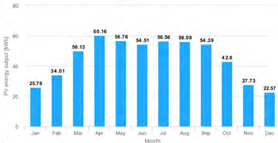
Abbildung 34: 600 W Balkonsolaranlage mit Aufhängung 70° (Quelle PVGIS [https://re.jrc.ec.europa.eu/pvg\\_tools/en/](https://re.jrc.ec.europa.eu/pvg_tools/en/))
