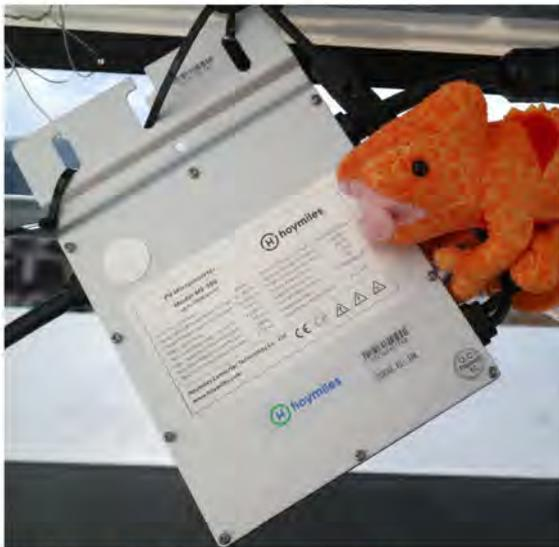
Abbildung 15: Mikrowechselrichter
