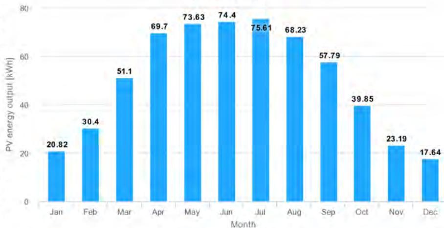
Abbildung 33: 600 W Balkonsolaranlage mit Aufhängung 30° (Quelle PVGIS [https://re.jrc.ec.europa.eu/pvg\\_tools/en/](https://re.jrc.ec.europa.eu/pvg_tools/en/))
